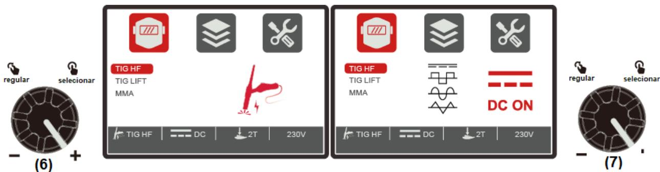
**(02) Seleção e configuração do método de soldagem:**
