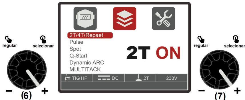
**(3) Interface de configuração do sistema:** um parâmetro do sistema e seu valor correspondente podem ser selecionados e definidos girando o encoder (6) e o encoder (7) na interface mostrada abaixo:
