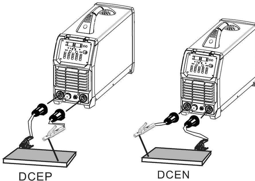
**MMA (DC):** O tipo de conexão, DCEN (negativo) e DCEP (positivo) depende da condição e do tipo de eletrodo e se a soldagem deve ser com maior ou menor penetração. Tipos diferentes de eletrodo necessitam de tipos diferentes de conexão, por favor, consulte as especificações técnicas dos fabricantes de eletrodos revestidos.
