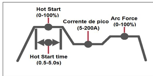
**Hotstart:** Fornece energia extra quando a solda começa para neutralizar a alta resistência do eletrodo e da peça de trabalho à medida que o arco é iniciado. faixa de ajuste (0-100%).
