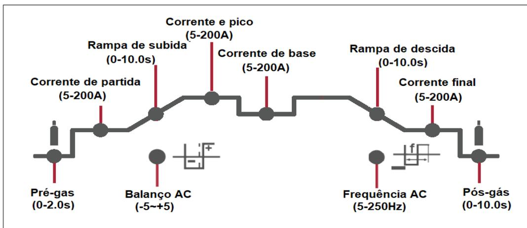
**Pré-gás:** O pré-gás controla o período em que o gás de proteção fluirá quando a tocha for acionada, antes do início do arco. Isso limpa a área de trabalho do gás atmosférico que pode contaminar a solda antes do início da solda. Unidade(S) e faixa de ajuste (0,1-2S).
