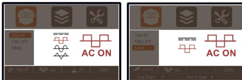
**(2) Interface de configuração de parâmetros de soldagem:** um parâmetro de soldagem e seu valor correspondente podem ser selecionados e ajustados girando o encoder (6) e o encoder
