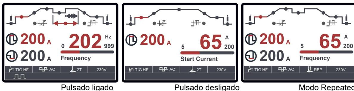
2) Na interface de configuração dos parâmetros de soldagem, o encoder (6) seleciona os parâmetros requeridos e o encoder (7) define um valor para os parâmetros.
