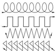
3. Deslocamento lateral do eletrodo em relação ao eixo do cordão (tecimento). Este movimento é utilizado para se depositar um cordão mais largo, fazer flutuar a escória, garantir a fusão das paredes laterais da junta e para tornar mais suave a variação de temperatura durante a soldagem. O tecimento deve ser, em geral, restrito a uma amplitude inferior a cerca de 3 vezes o diâmetro do eletrodo. O número de padrões de tecimento é muito grande. Veja ao lado.
