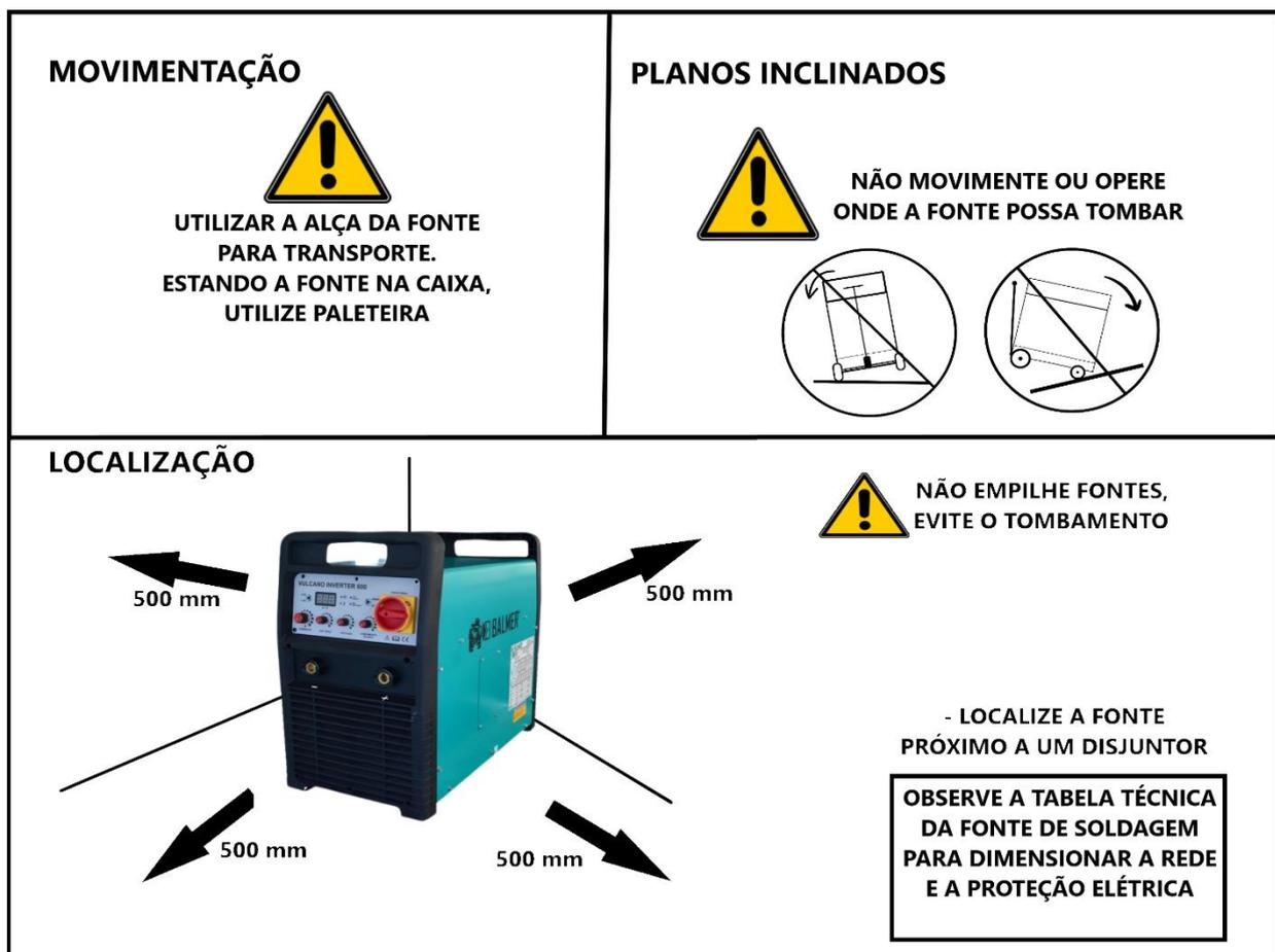
Figura 2 – Atribuições do local de instalação
