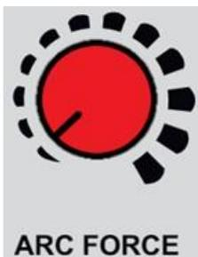
Esta função regula a intensidade com que o equipamento agirá para manter o arco elétrico aceso. Atuará assim que o comprimento do arco estiver muito curto (eletrodo muito próximo da peça) e a tensão de solda estiver abaixo de 20 VDC.
